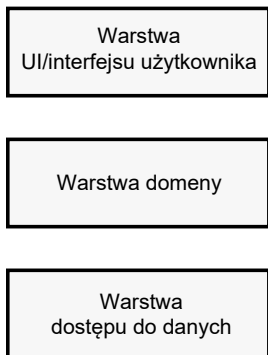
Rysunek 2.1. Standardowa architektura trójwarstwowej aplikacji. Jest to najprostszy i najczęściej spotykany wariant architektury n -warstwowej aplikacji, gdzie aplikacja jest stworzona z n różnych warstw
